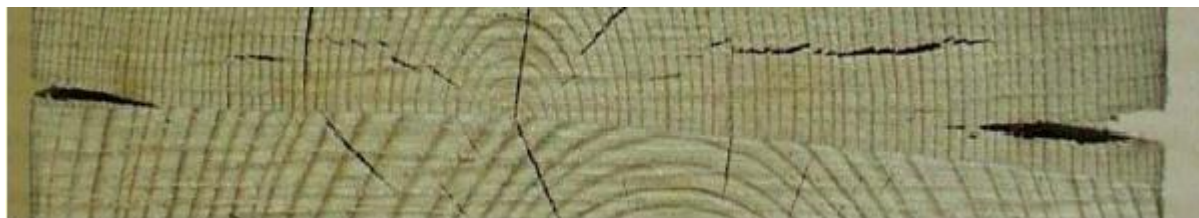
Фото 2. Увеличенная часть образца 3.2.2 видны больше трещины в древесине параллельно клеевому шву. Сам клеевой шов остался целым.
