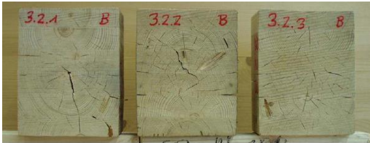
Фото 1. Сторона В 3-х образцов после теста на расслаивание: визуальные трещины в древесине в зависимости от произведенных испытаний. Клеевые швы остались абсолютно невредимыми.
