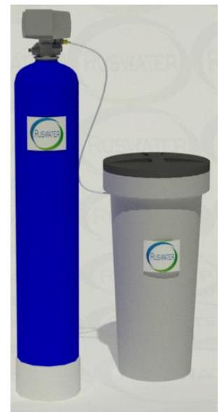
Периодическая загрузка соли в бак осуществляется обслуживающим персоналом. Сигнал к началу регенерации поступает от встроенного водосчетчика, регистрирующего объем воды, прошедшей через установку. Работа установки полностью автоматизирована и не требует постоянного присутствия обслуживающего персонала. Во всех операциях процесса регенерации одного фильтра используется исходная вода.
