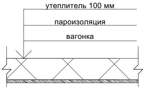
"Пирог" перекрытия 2 этажа
